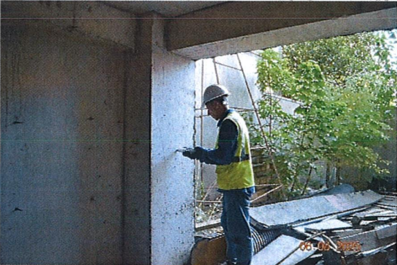
სურ. 13. რკ/ბ სვეტის ბეტონის სიმტკიცის დადგენა
