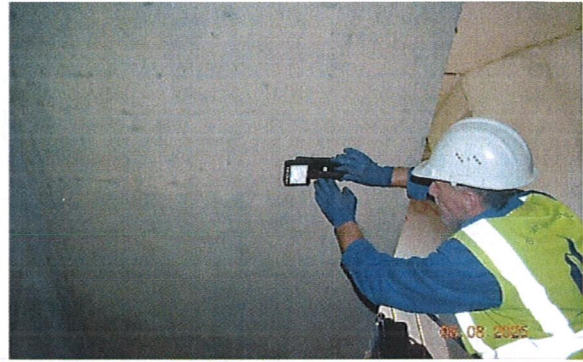
სურ. 81. რკ/პ პანდუსის ბეტონის სიმტკიცის დადგენა სურ. 82. რკ/პ პანდუსში დარმირების გამოკვლევა
