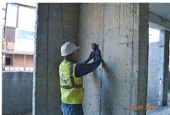
სურ. 69. ბეტონის სიმტკიცის განსაზღვრა რკ/ბ კედელზე. სურ. 70. დაარმირების გამოკვლევა რკ/ბ კედელში.
