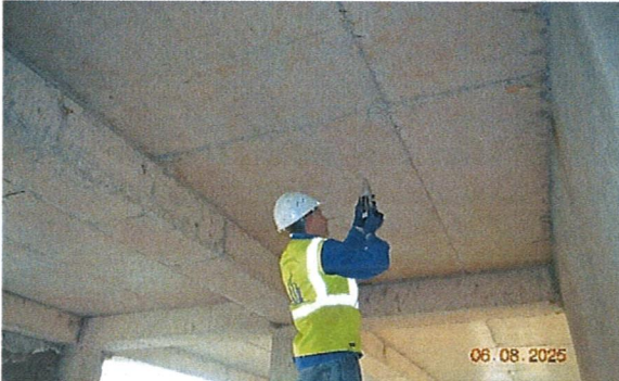
სურ. 43. ბეტონის სიმტკიცის განსაზღვრა რკ/ბ ფილაზე
