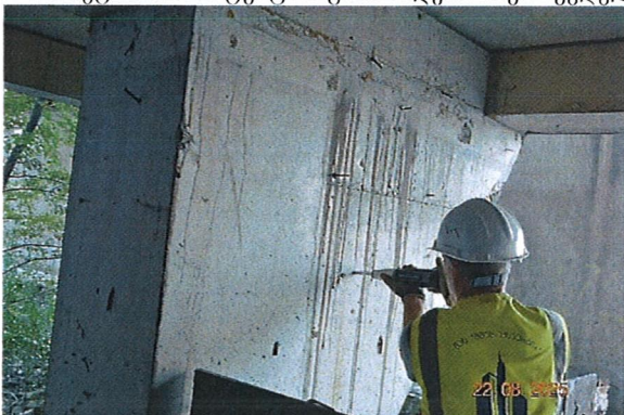
სურ. 73. ბეტონის სიმტკიცის განსაზღვრა რკ/ბ კედელზე. სურ. 74. რკ/ბ კედელში არმატურის დიამეტრის დადგენა.
