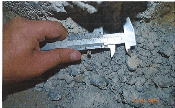
სურ. 20. რკ/ბ სვეტის ფრაგმენტული გახსნა, არმატურის დიამეტრის დადგენა.
