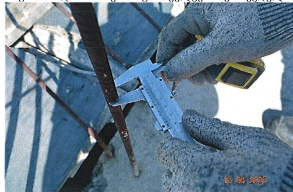
სურ. 60. რკ/ბ კედლის არმატურის ღეროების ნაშევრების დიამეტრის დადგენა
