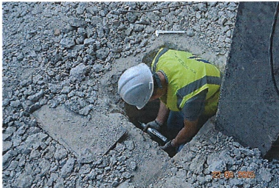
სურ. 87. რ/ბ როსტვერკი (რანდკოჭი), ბეტონის სიმტკიცის დადგენა
