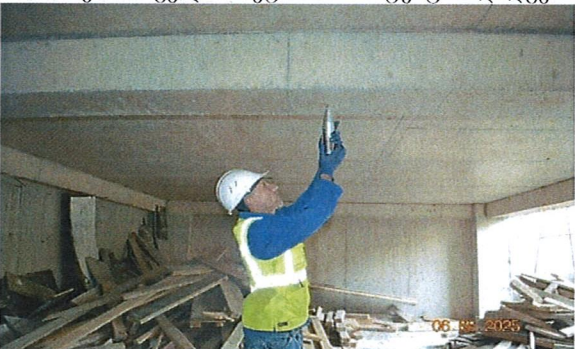
სურ. 31. რკ/ბ რიგელის ბეტონის სიმტკიცის დადგენა სურ. 32. დაარმირების გამოკვლევა რკ/ბ რიგელში.
