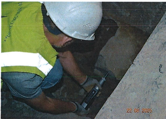
სურ. 7. რკ/ბ ტუმბო-ხიმინჯი, ბეტონის სიმტკიცის დადგენა.
