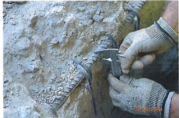
სურ. 88. რ/ბ როსტვერკი (რანდკოჭი), არმატურის დეროს დიამეტრის დადგენა
