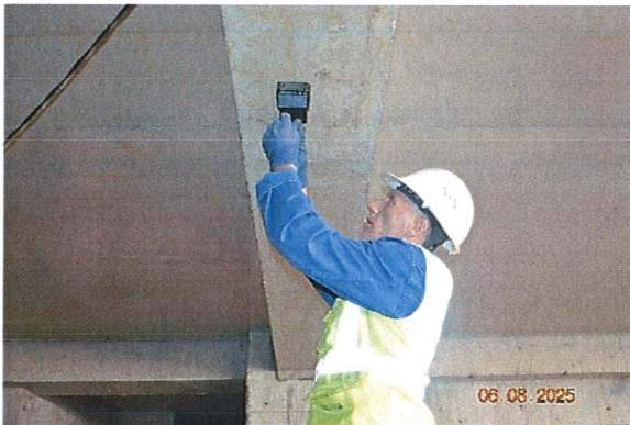
სურ. 27. დაარმირების გამოკვლევა რკ/ბ რიგელში. სურ. 28. რკ/ბ რიგელის ბეტონის სიმტკიცის დადგენა
