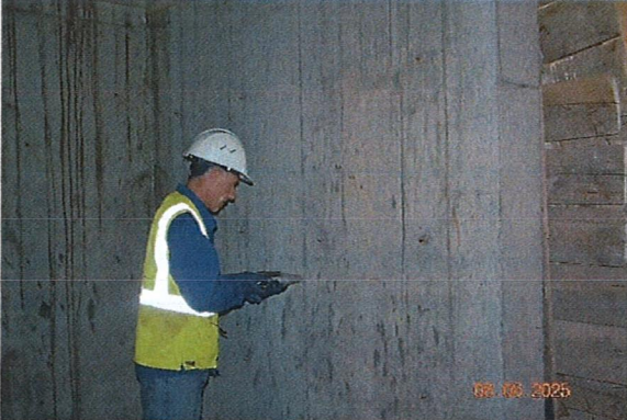
სურ. 57. ბეტონის სიმტკიცის განსაზღვრა რკ/ბ კედელზე
