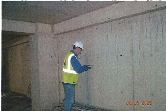
სურ. 65. ბეტონის სიმტკიცის განსაზღვრა რკ/ბ კედელზე სურ. 66. დაარმირების გამოკვლევა რკ/ბ კედელში
