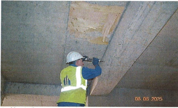
სურ. 33. რკ/ბ რიგელის ბეტონის სიმტკიცის დადგენა
