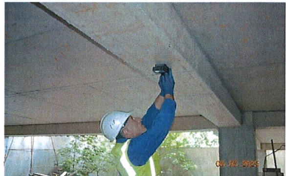
სურ. 29. რკ/ბ რიგელის ბეტონის სიმტკიცის დადგენა სურ. 30. დაარმირების გამოკვლევა რკ/ბ რიგელში.
