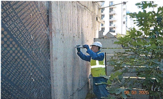
სურ. 45. ბეტონის სიმტკიცის განსაზღვრა რ/ბ კედელზე
