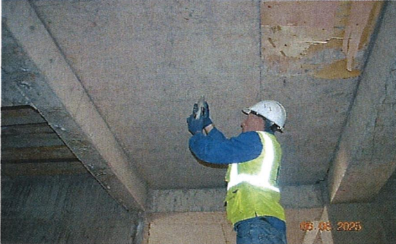
სურ. 41. ბეტონის სიმტკიცის განსაზღვრა რკ/ბ ფილაზე
